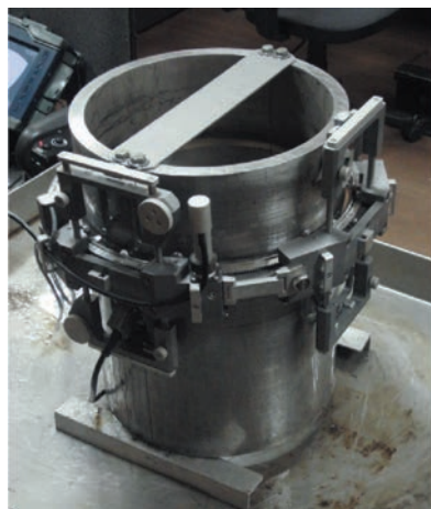
Сканер стоит на образце сварного соединения ДУ 300
