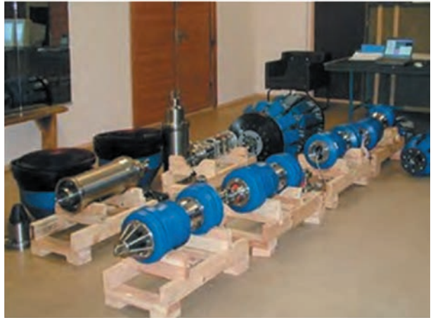
Сдача разработки по внутритрубному дефектоскопу заказчику ОАО «Диаскан»
